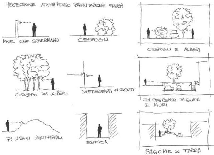
Figura 3 –Schermi di delimitazione dei percorsi e delle aree interne al nodo di scambio - Schemi grafici
